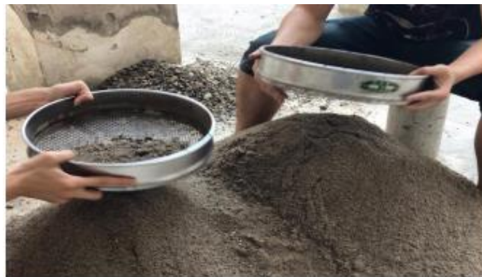
Hình 1: Sàng cát loại bỏ các hạt cốt liệu lớn
